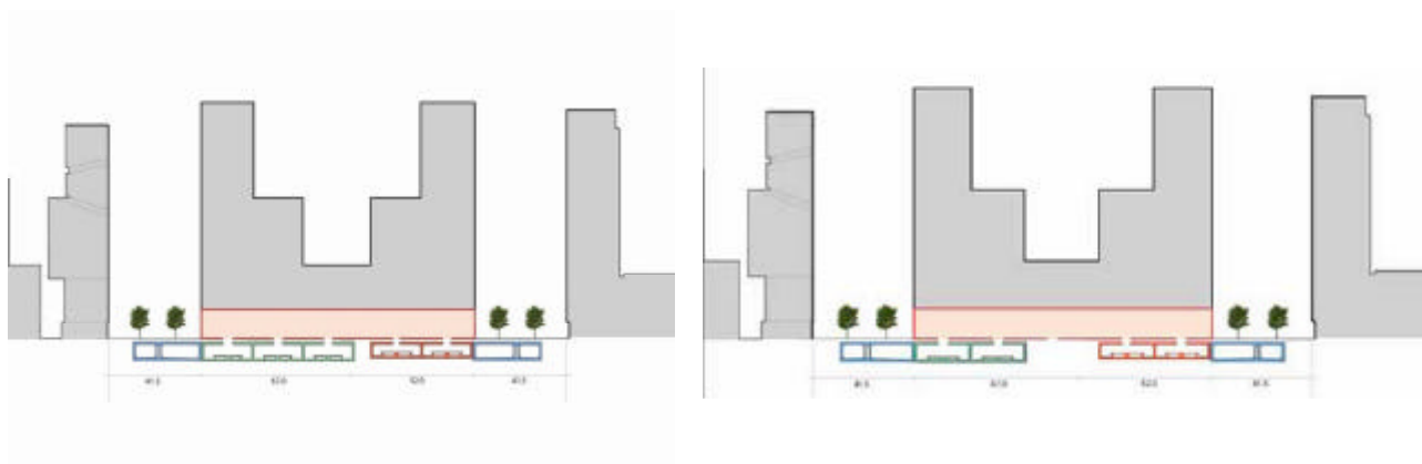
figuur 3.14 Schematische weergave van alternatief 1 (links: 6 sporen en rechts: 4 sporen)
