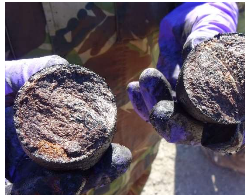
Figuur 64 Opengebroken hoofdloading van één van de 60 mm mortiergranaten. Metalen wand is volledig doorgeroest.
