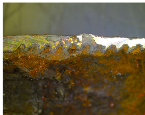
Figuur 58 Detail schroefdraad M10-2 (radiale doorsnede).
