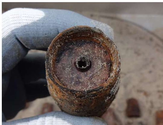
Figuur 23 Explosieve lading onder afgebroken punt met schokbuis.
