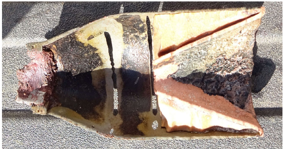
Figuur 11 M28A2 holle lading (M2) na het waterstraalsnijden.
