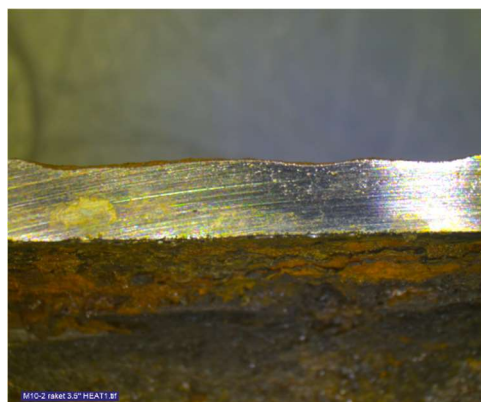
Figuur 57 Detail wanddikte M10-2 (radiale doorsnede).
