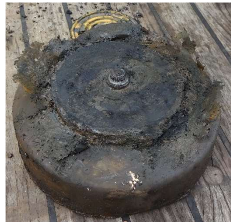
Figuur 15 M1, nr 25 Nederlandse AT schotelmijn hoofdlading met dunne restanten van het omhulsel.
