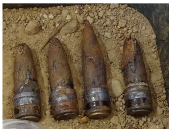
Figuur 29 Vier van de vijf 37 mm oefengranaten. Significante afname in wanddikte te zien rond de geleideband en aan de punt.
